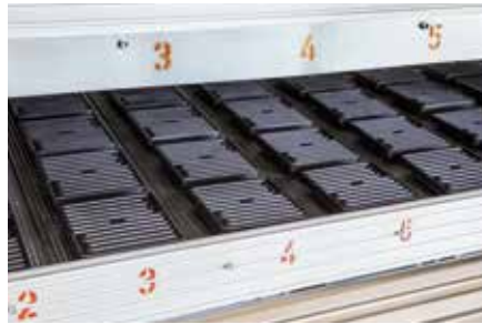
Heizung mit effizienten HTS Keramik-Strahlern
